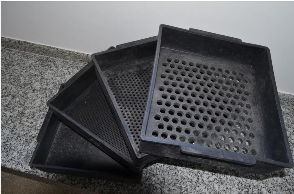
**Figura 1.** Montagem do separador de partículas Penn State Particle Separator (PSPS). De baixo para cima: fundo liso, peneira com crivos de 4 mm, peneira com crivos de 8 mm e peneira com crivos de 19 mm. Fonte: arquivo próprio.
